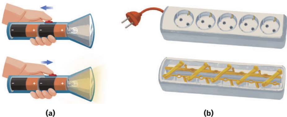
Gambar 5.13 (a) Rangkaian Seri pada Senter dan (b) Rangkaian Paralel pada Stop Kontak
