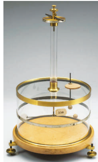
Gambar 5.5 Eksperimen Percobaan Coulomb untuk Menentukan Muatan Listrik
